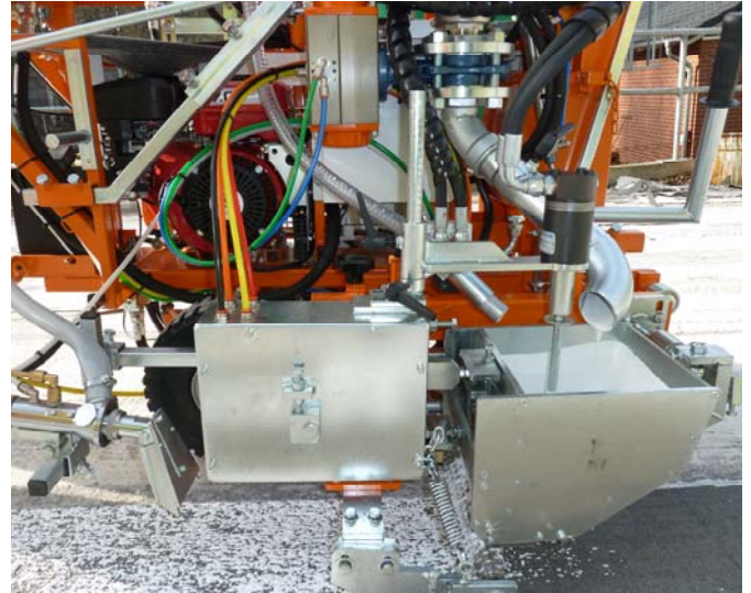
Abbildungen zeigen Durozet – 200 mit Ausrüstung für Strukturmarkierungen
