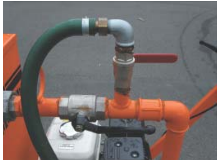
Regulierung der Pumpenfördermenge
