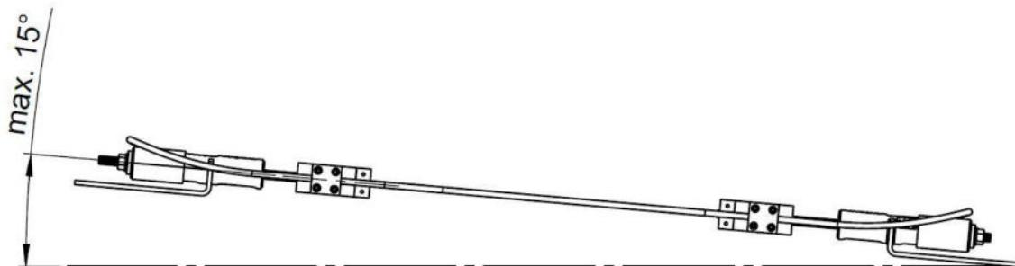
L'angolo di ingresso delle funi nei componenti del sistema è massimo 15°.
